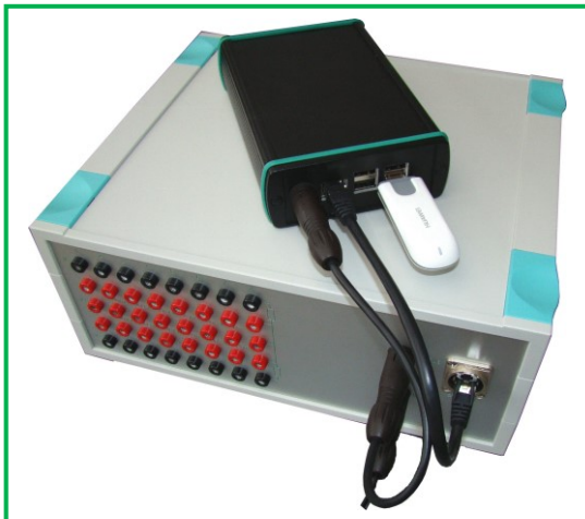
MessBox MBO32 Frontansicht und separatem RasPi-Logger
