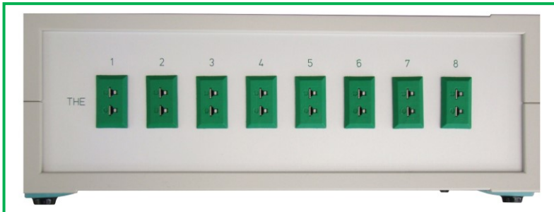
MessBox MBO16 Rückseite mit 8 Thermoelementeingängen THE
