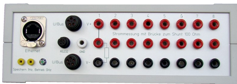
MessBox MBI16 Frontansicht mit 8 analogen Eingängen UIE und den Schnittstellen: Ethernet, RS485 und RS232
